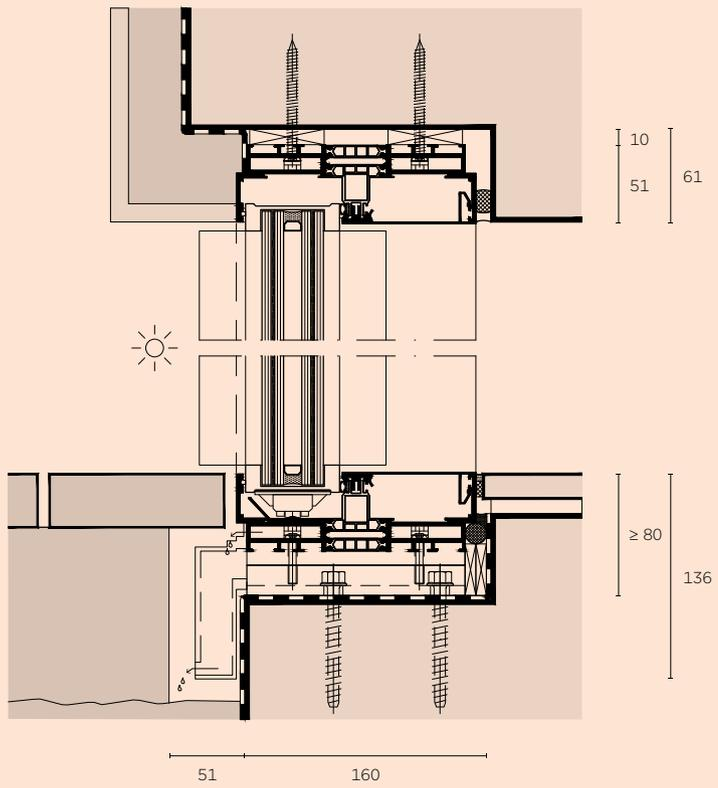
**Horizontalschnitt, 2 Gleise**
