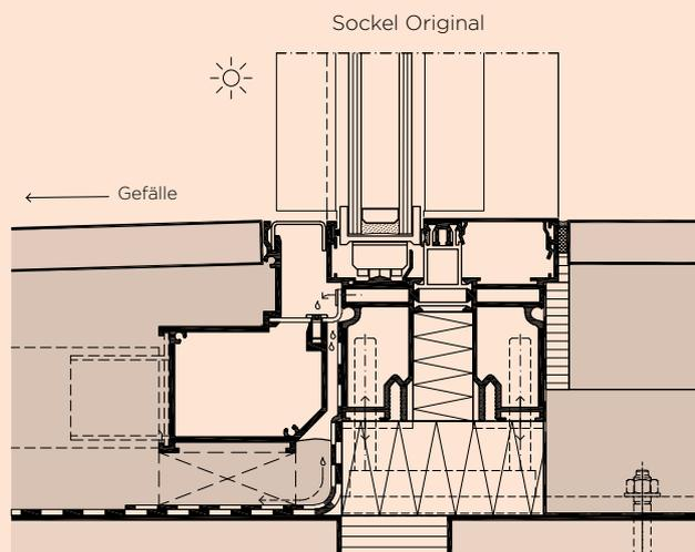
Der Socket Original klein ist optional erhältlich für Länder, in denen ein niedriger Bodenaufbau üblich und konform ist.
