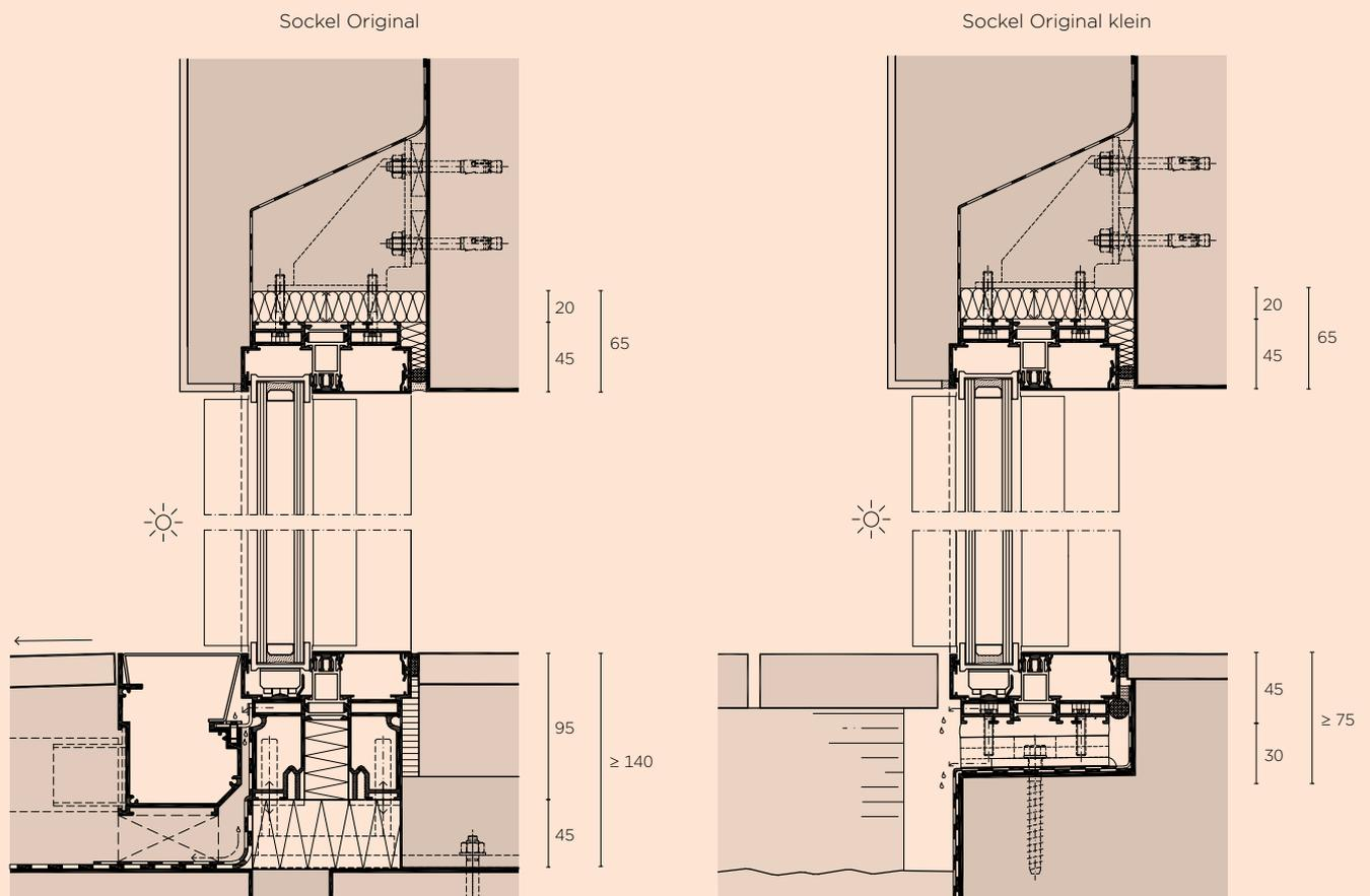
Der Sockel Original klein ist optional erhältlich für Länder, in denen ein niedriger Bodenaufbau üblich und konform ist.
